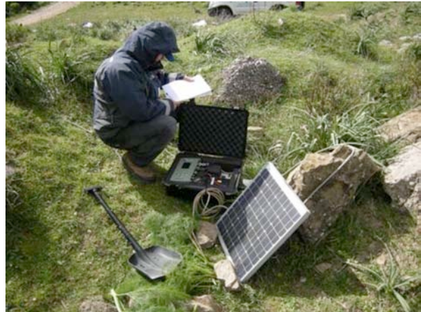
Figura 2. Esempio di installazione di una stazione sismica mobile, e relativo sistema di alimentazione.
