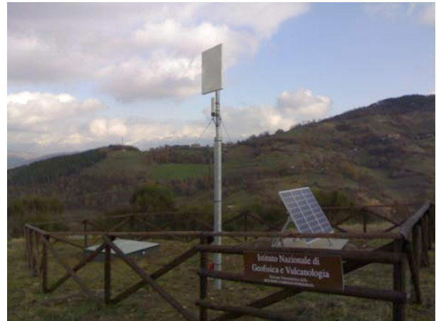
Figura 2. Esempio di apparati radio e pannelli solari utilizzati nelle stazioni della rete AVT.
