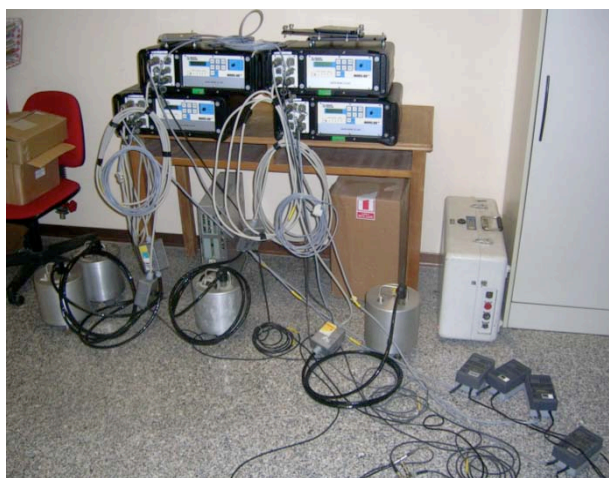
Figura 1. 4 stazioni sismiche Lennartz Mars88-FD equipaggiate con sensori Mark L4C-3D (1 Hz).
