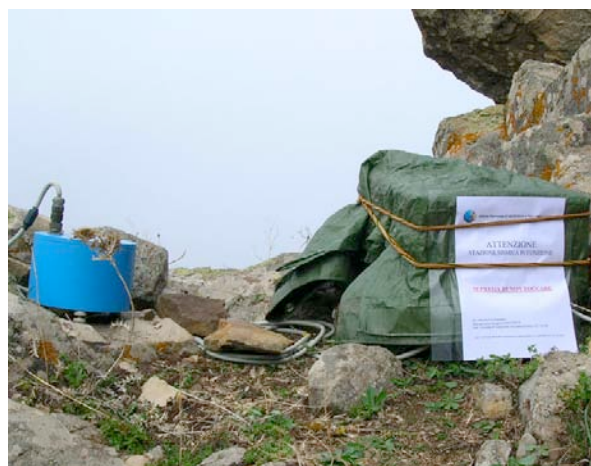
Figura 2. Re.Mo.: esempio di installazione di una stazione sismica stand-alone .
