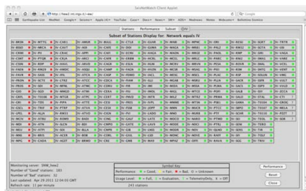
Figura 5. Il pannello di SeisNetWatch mostra lo stato di funzionamento della rete IV.
