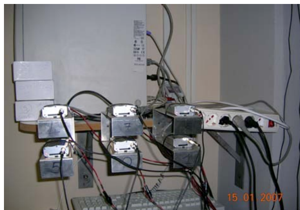
Figura 2. Sistema di acquisizione della RSA basato su 6 seriali collegate a modem GSM .
