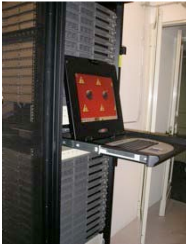
Figura 3. Il Beowulf cluster presente all'INGV-CT.
