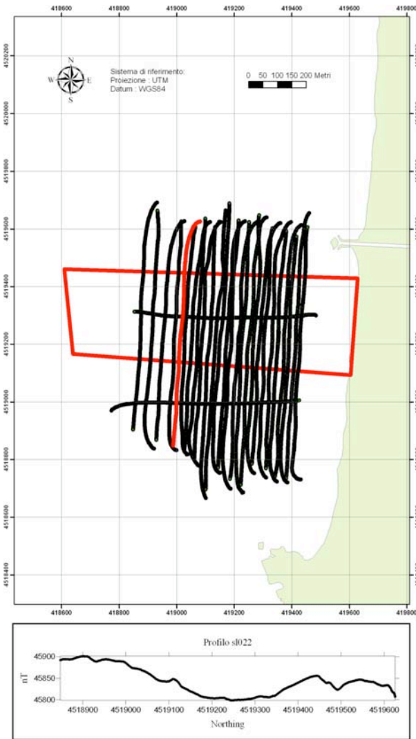
Figura 6. Grigliato di acquisizione del rilievo magnetico di alta risoluzione eseguito a Torregaveta (Campi Flegrei) con in rosso evidenziato il profilo sl022 per il quale viene riportato il profilo magnetico in basso. In rosso la fascia dove dovrebbe essere ubicato il nuovo cavo.
