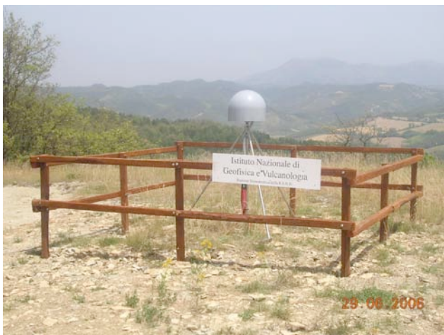
Stazione ATPI - Antenna GPS posta a circa 30 metri dalla stazione sismometrica.
