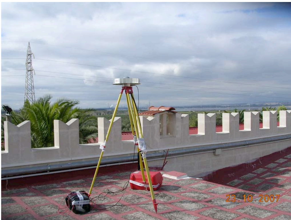
Figura 5. Particolare dell'installazione della strumentazione GPS utilizzata come reference per il rilievo RTK nell'area di San Giorgio Jonico.
