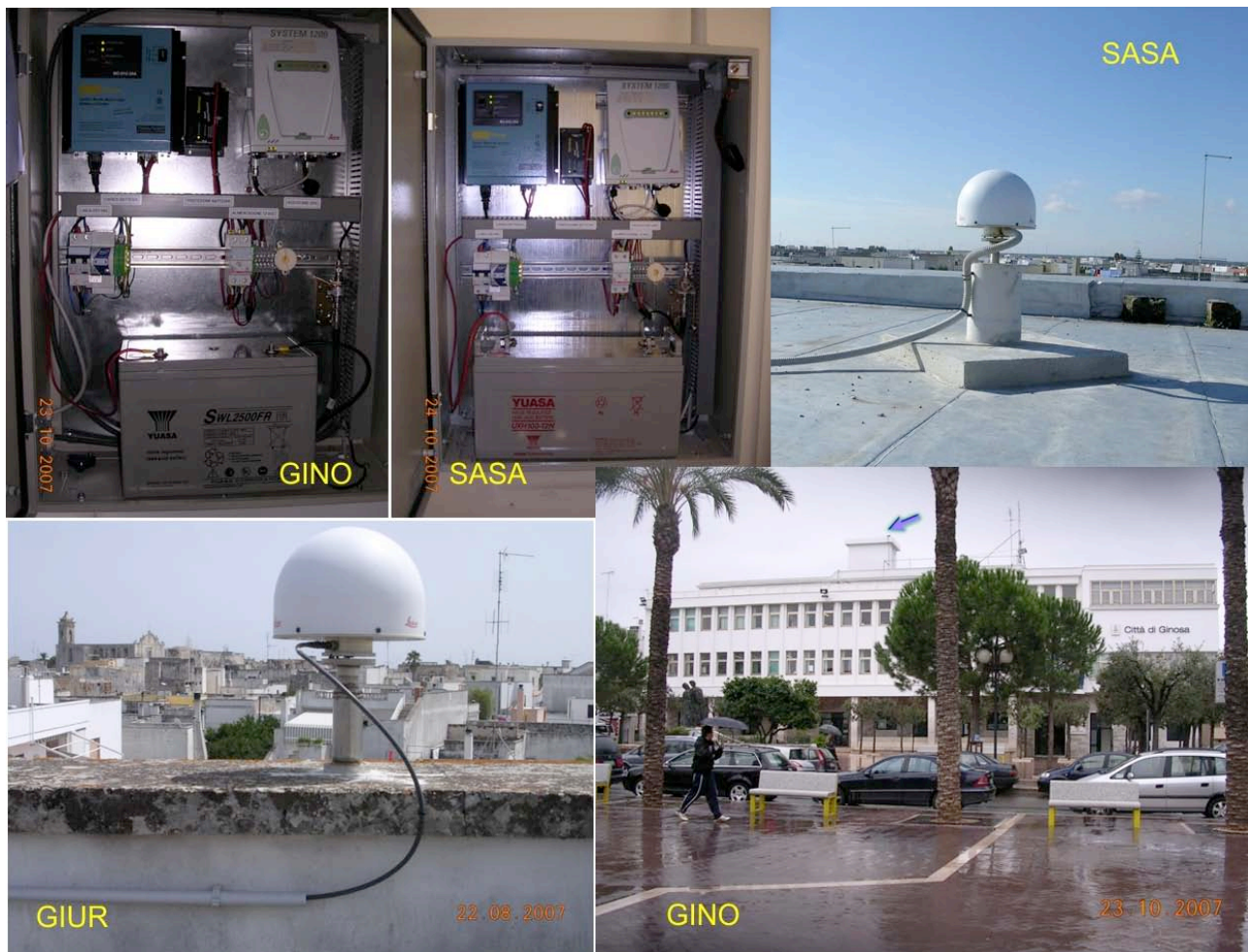
Figura 2. Monumentazione e strumentazione installata presso Ginosia (GINO) , Salice Salentino (SASA) e Giurdignano (GIUR) e manufatto su cui è installata la stazione di Ginosia (la freccia viola indica la posizione dell'antenna GPS).
