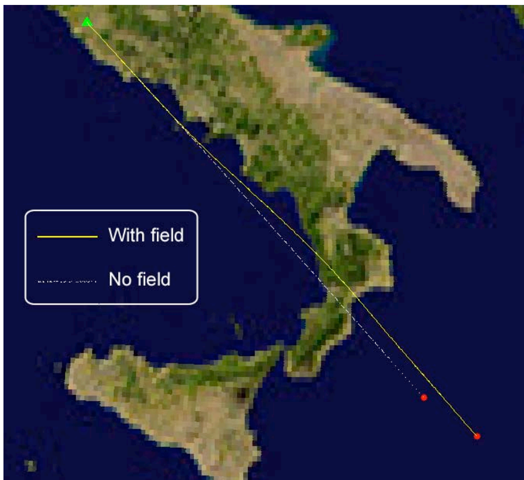
Figura 7. Percorso di raggio con e senza campo magnetico. Coordinate 41.8^\circ \text{ N} - 12.5^\circ \text{ E} , Frequenza 8 MHz, Elevazione 45^\circ , Azimut 135^\circ (errore relativo sulle coordinate geografiche di 10^{-4} ).
