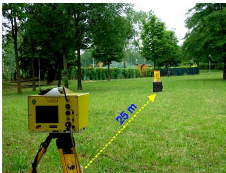
Figura 4. Fotografia del rilievo dalla prima posizione di 25 m. La posizione è stata misurata mediante cordella metrica e lo scanner è stato orientato per essere il più normale possibile al target.
