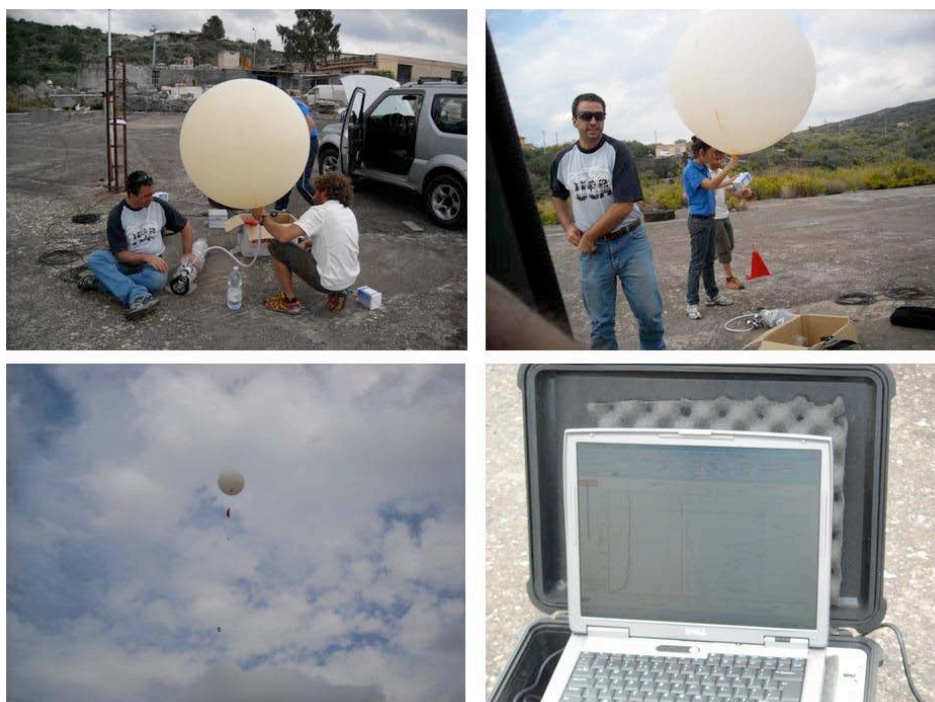
Figura 8. Sequenza della procedura effettuata quando si lancia il pallone di radiosondaggio.
