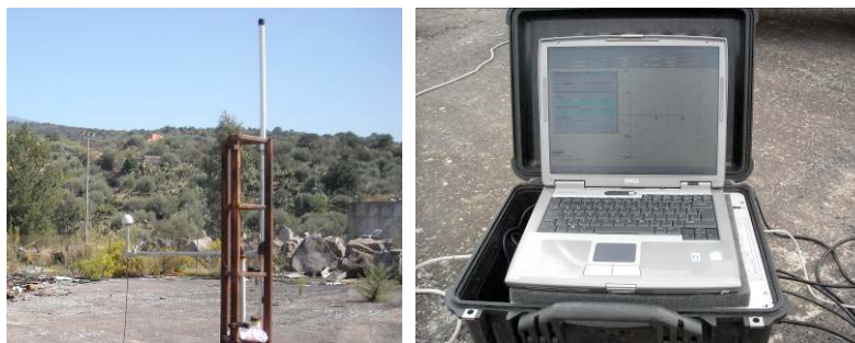
Figura 7. Posizionamento dell'antenna GPS e fase di inizializzazione della Ground Station.
