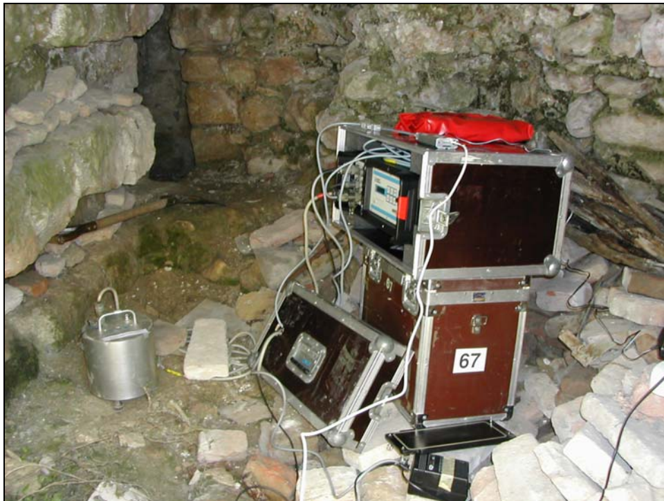
Fig. 1b Stazione sismica Mars88 Modem Control in fase d'installazione.
