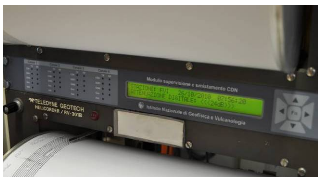
Figura 17. I due rack da quattro helicorder montati in sala sismica.
