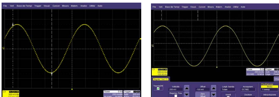
Figura 3. Andamento della forma d'onda di una sinusoida di prova in uscita al DAC prima e dopo il filtro.
