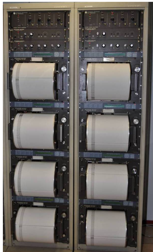
Figura 17. I due rack da quattro helicorder montati in sala sismica.
