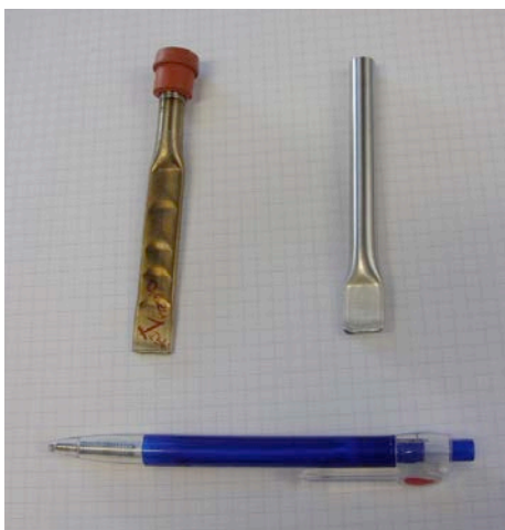
Figura 2. Portacampione all'interno del quale vengono inseriti i cristalli: a destra prima del crushing , a sinistra dopo il crushing .
