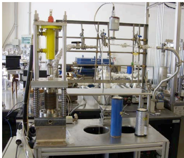
Figura 4. Linea in vetro per la purificazione della CO 2 dalla miscela gassosa rilasciata dalle inclusioni fluide dopo macinazione dei cristalli tramite crusher (a sinistra nella foto).
