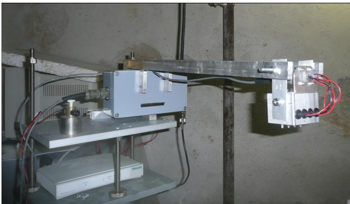
Figura 4. Il dispositivo di calibrazione con i quattro laser di calibrazione.
