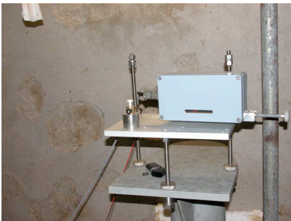
Figura 3. Rivelatore PSD e laser di misura. Il raggio di luce emesso dal laser di misura, a sinistra del rivelatore, viene riflesso dallo specchio montato sull'asta del pendolo. La feritoia nera del rivelatore è l'ingresso ottico dove incide la luce laser riflessa. Il rivelatore, in una scatola stagna, contiene un processore che condiziona l'uscita e produce un segnale seriale per il calcolatore d'acquisizione.
