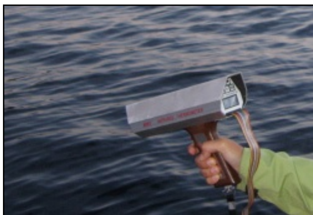
Figura 3. Termometro IR: modalità di acquisizione in mare.
