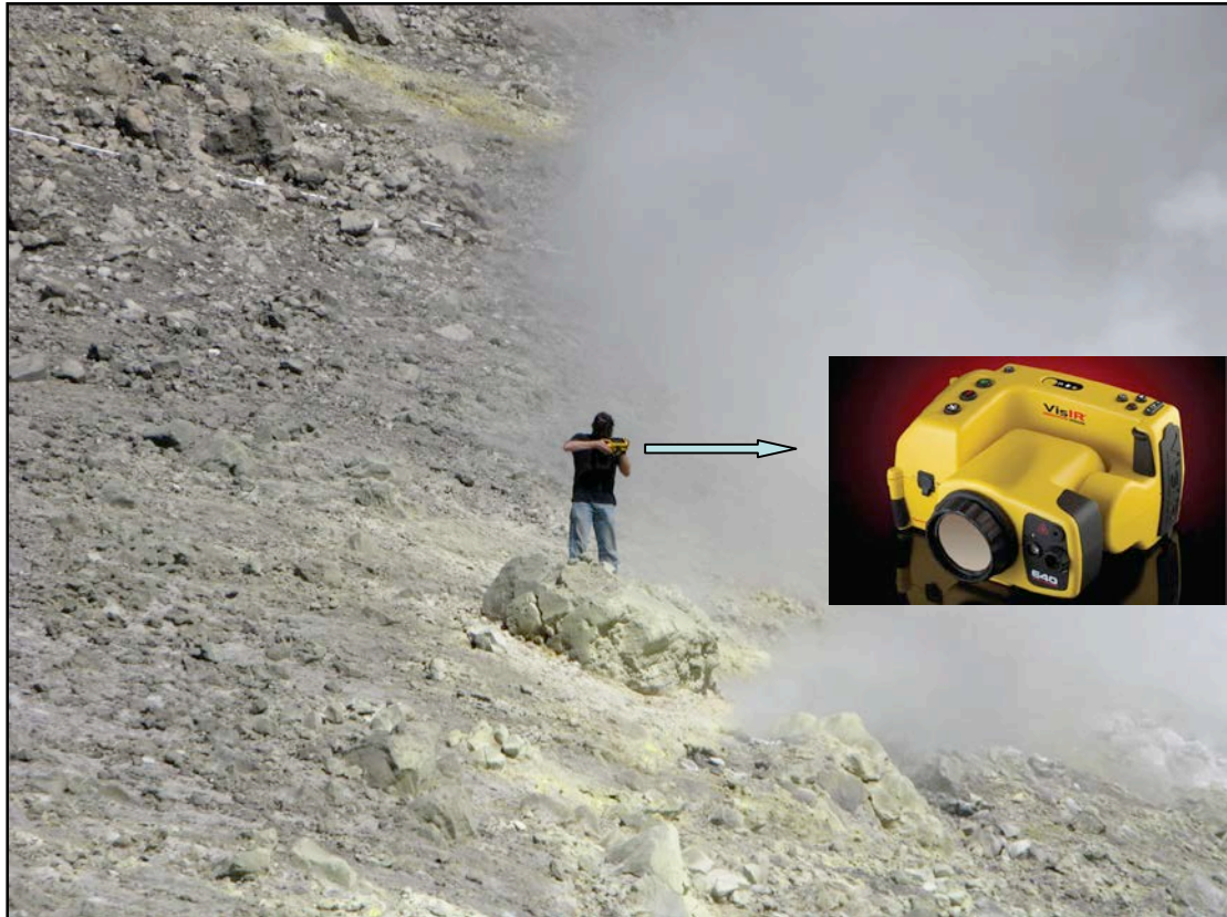
Figura 5. Camera Termica: acquisizione di dati nella zona del Cratere La Fossa.
