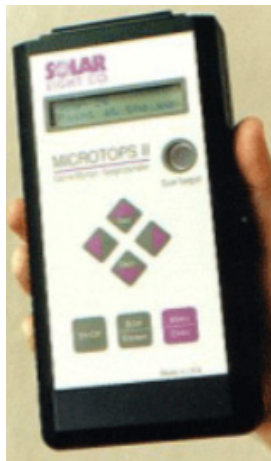
Figura 7. a) Fotometro portatile Microtops II. b) Spessore ottico misurato nella zona del molo di attracco dei traghetti di Vulcano (10/09/2010).
