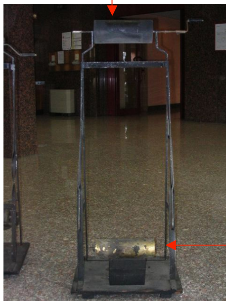
Fig. 2.2.1 – Dispositivo per affumicatura dei fogli.
