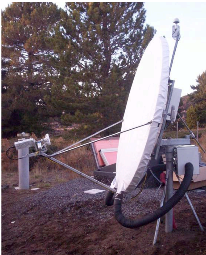
Fig. 1 Antenna parabolica di ESLN equipaggiata con il sistema di De-Icing
