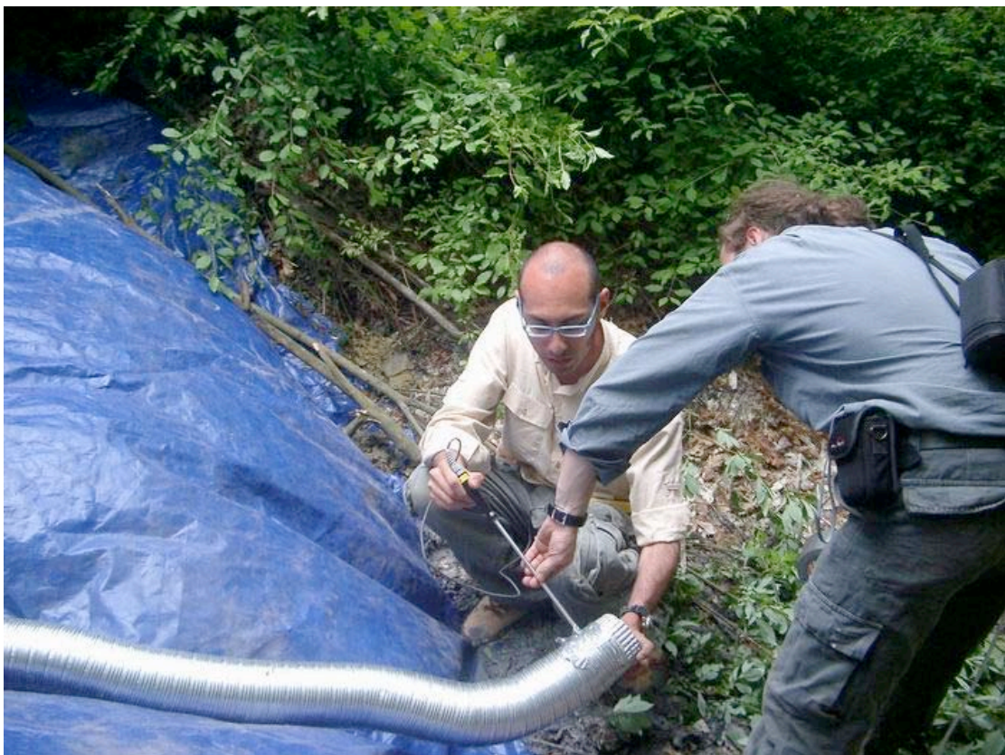
Foto 8. Colle Monticchio : installazione della sonda anemometrica “a filo caldo” costituente la parte terminale del sistema SAP. (foto: S. Mecozzi)
