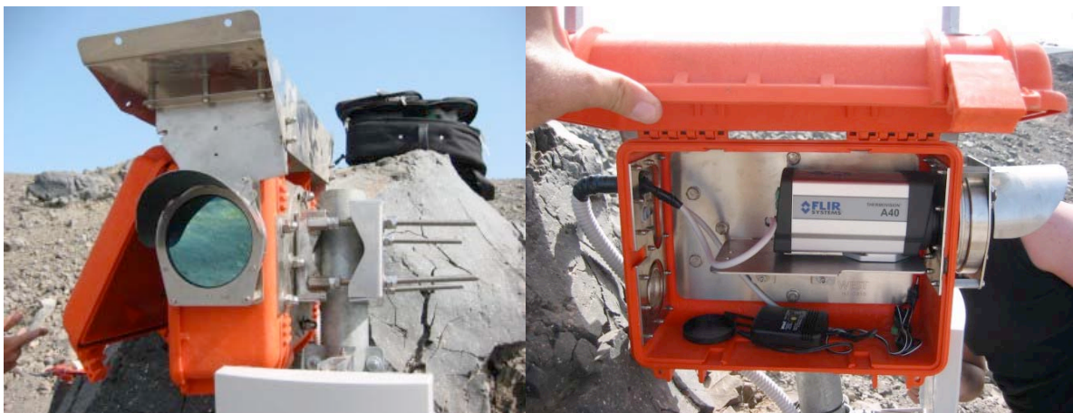
Fig. 4. Particolare della custodia stagna contenente la telecamera FLIR A 40 M installata al cratere "La Fossa" di Vulcano.
