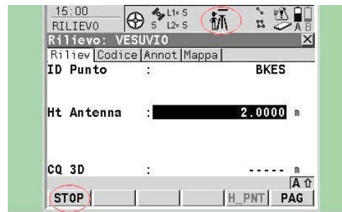
Figura 49 La presenza del tasto funzione F1 (stop) e dell'icona in alto al centro dello schermo (omino fermo vicino al treppiede), confermano che la misura è stata avviata correttamente.
