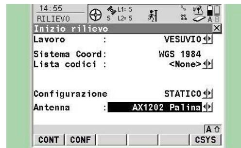
Figura 47 Scegliere il lavoro, il sistema di coordinate (in genere WGS84), la lista codici (può essere nessuna), verificare la configurazione (statico) e selezionare il tipo di antenna (ad es. AX1202 Palina). Premere invio o il tasto funzione F1 (cont) .
