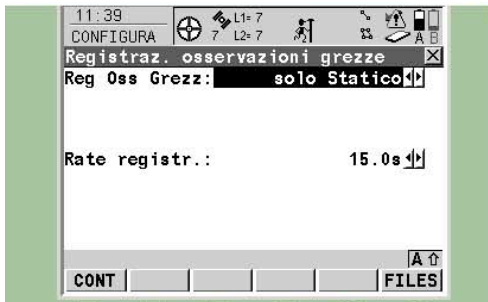
Figura 40 Si ritorna alla schermata precedente registrazioni osservazioni grezze . Premere il tasto invio o tasto di funzione F1 (cont) .
