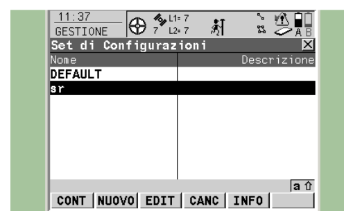
Figura 35 Con il cursore selezionare il set di configurazione tasto funzione F2 (nuovo) crearne uno nuovo.
