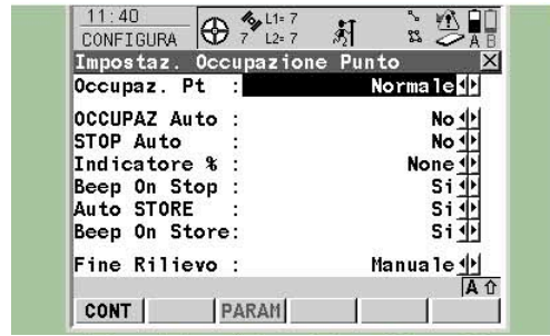
Figura 41 Impostare, STOP Auto e auto STORE per recuperare i dati in caso di spegnimento accidentale. Premere invio o F1 (cont) .
