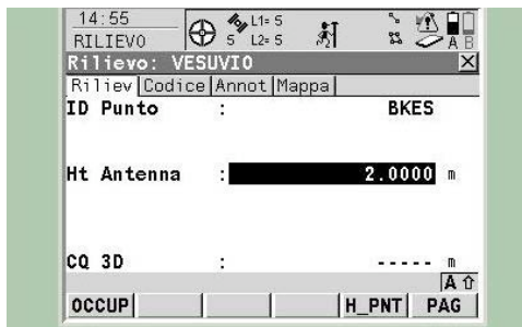
Figura 48 Inserire il nome del punto da misurare (ad es. BKES), e impostare l'altezza dell'antenna. Premere invio o il tasto funzione F1 (occup).
