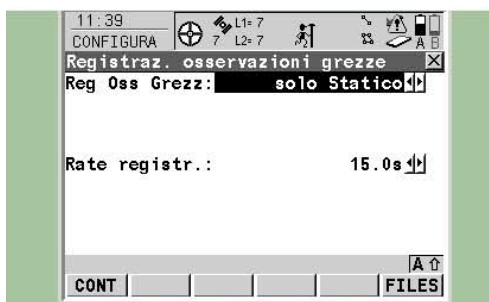
Figura 38 Scegliere il tipo di osservazioni , solo statico . Selezionare il rate di registrazione (ad es. 15 secondi ) e premere il tasto funzione F6 (files) .
