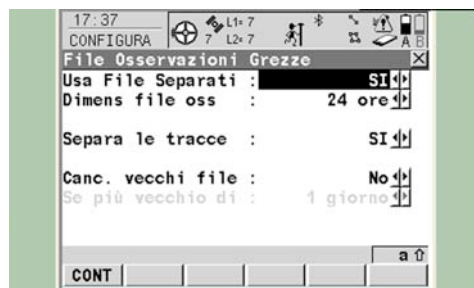
Figura 39 Scegliere il tipo di file (singolo) , la durata ( 24 ore ), con tracce separate, poi scegliere se i vecchi file registrati siano cancellati (meglio scegliere l'opzione di non cancellarli). Premere F1 .
