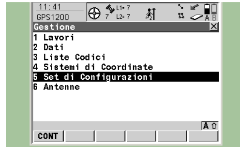
Figura 44 Si ritorna al menù Gestione. Premere invio o il tasto funzione F1 (cont) .
