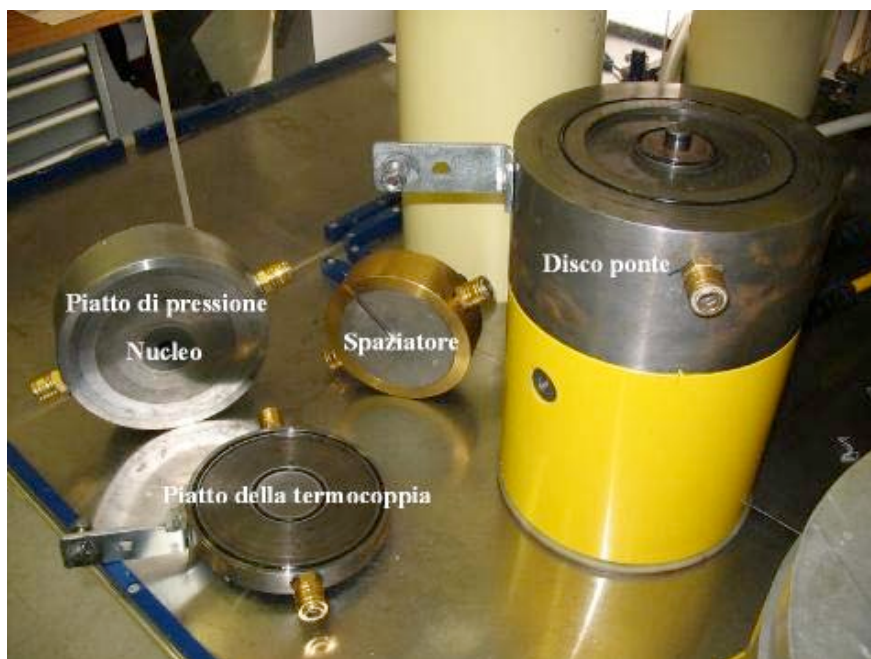
Figura 3. Elementi costitutivi del piston cylinder end-loaded in dotazione presso l'Istituto Nazionale di Geofisica e Vulcanologia di Roma.
