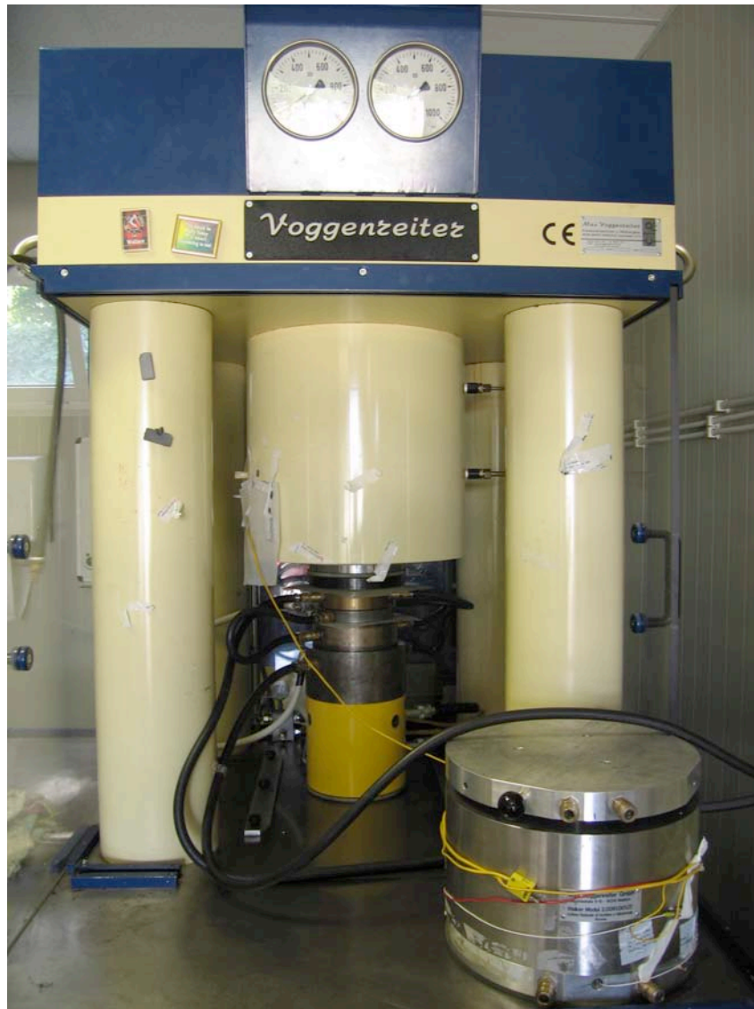
Figura 1. Il piston cylinder del Laboratorio Alte Pressioni ed Alte Temperature dell'INGV di Roma 1.
