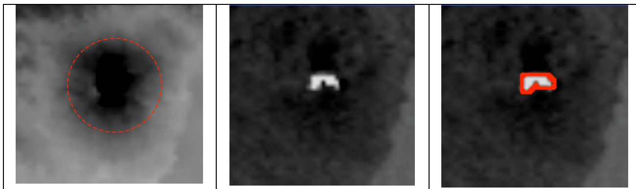
Figura 7 Zona sommatiale dell'Etna (pixel neri) caratterizzata da un'omogenea distesa di colate laviche (a); anomalia termica visibile nell'immagine AVHRR del 30/10/2006 (b) e relativo contour generato per la stima della temperatura di background (c).
