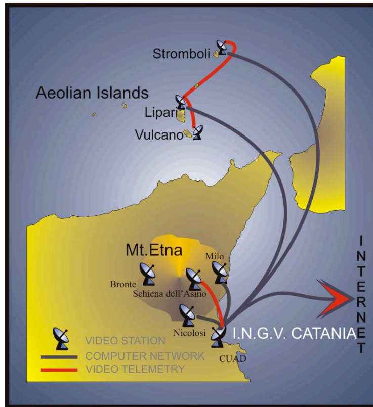
Figura 1. Ubicazione delle stazioni di monitoraggio video e termico dell'Etna e delle Isole Eolie.
