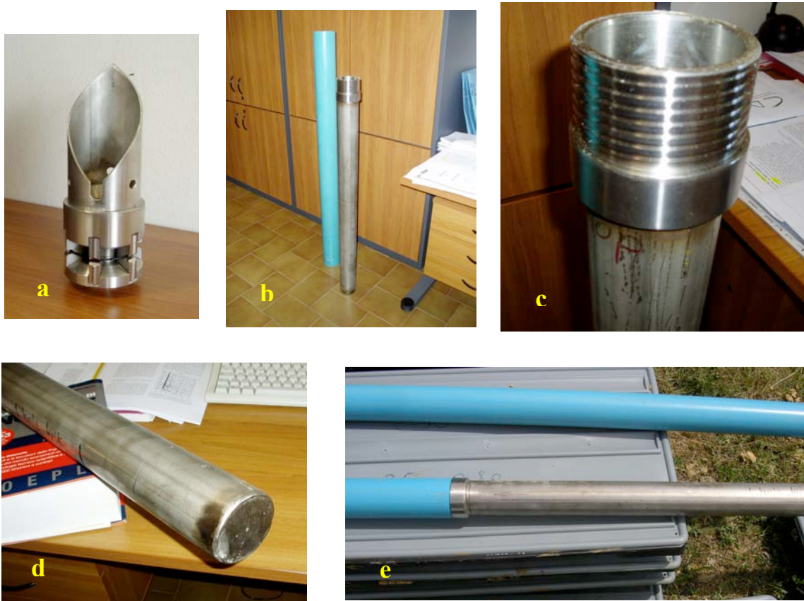
Figura 2.1 Incamiciatura in acciaio che ospita il sistema di ancoraggio del sensore di profondità (a). In (b) è mostrato il tubo in acciaio che costituisce la parte terminale dell'incamiciatura del foro, (c) e (d) mostrano due particolari rispettivamente della parte sommitale filettata e quella basale chiusa da un coperchio saldato. La fig. (e) mostra l'accoppiamento del tubo in acciaio, alloggiamento del sistema di bloccaggio, al tubo di PVC che costituisce il rivestimento complessivo del foro.
