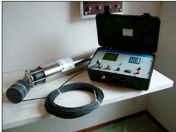
Figura 2. Transponder acustico: unità da fondo mare ed unità di superficie.
