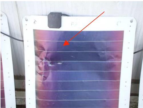
**Figura 11** Particolare del pannello 2. La freccia indica il punto del danneggiamento.
