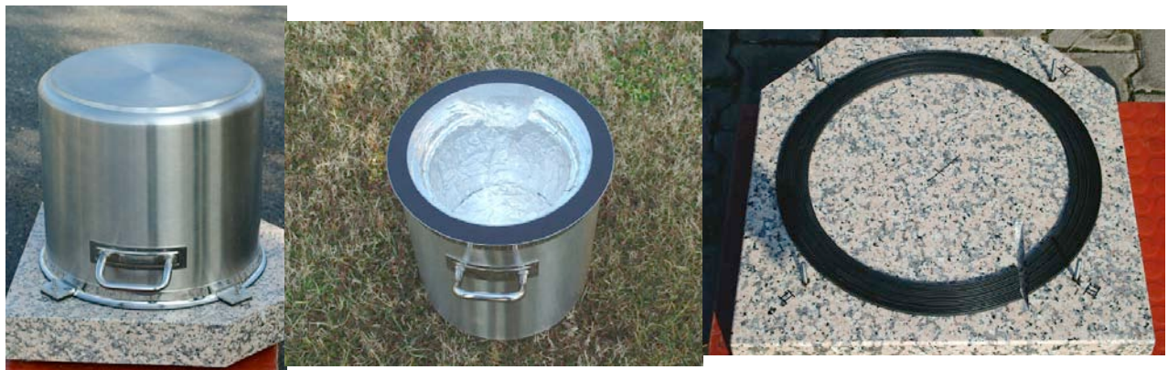
Figura 2 Schermo realizzato presso il laboratorio MedNet, da sinistra a destra: schermo e basamento, schermo rovesciato, basamento con guarnizione.
