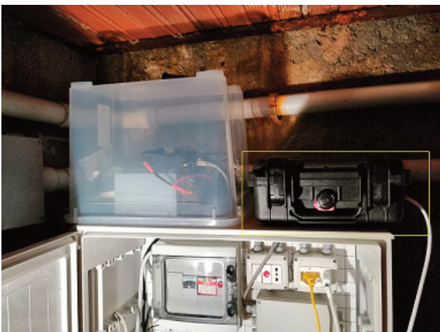
Figura 14 Nel riquadro: valigetta contenente sensore radon e acquirente installata presso la stazione sismica SRES (Monte Soratte).
